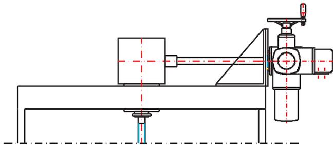
99.35 Antrieb mit E-Antrieb über Winkelgetriebe auf Traverse seitlich
